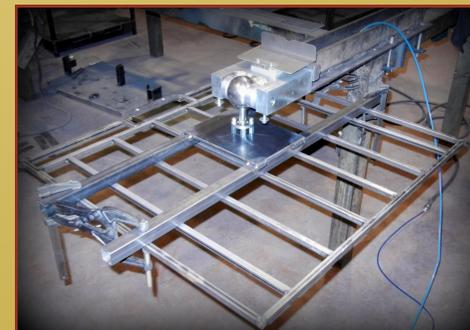
BOLARTFIX instalado sobre soporte longitudinal, banco de trabajo.
